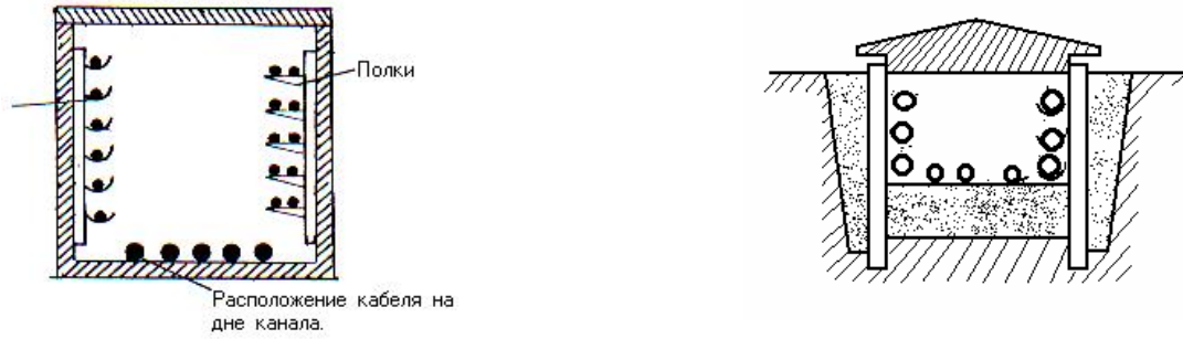
Рисунок 46 - Прокладка кабелей в каналах.
