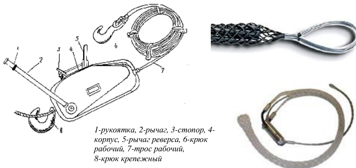
Рисунок 6 - Лебедка монтажная ручная, монтажные чулки для протяжки кабеля в трубах.
