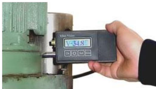
Рисунок 9 – Измерение вибрации с помощью ручного электронного вибрметра
