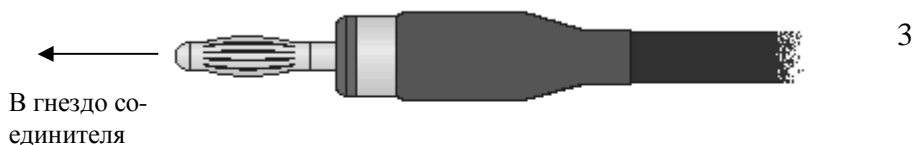
2 - Коннектор с зажатой жилой перед надеванием усадочной трубки
